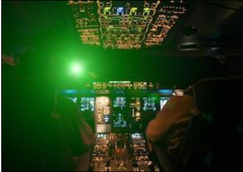
Figura 6. Iluminarea cabinei cu o lumină laser – vederea piloților este perturbată.
