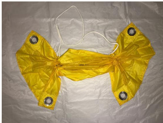
Fig B. Collapsed Slider
