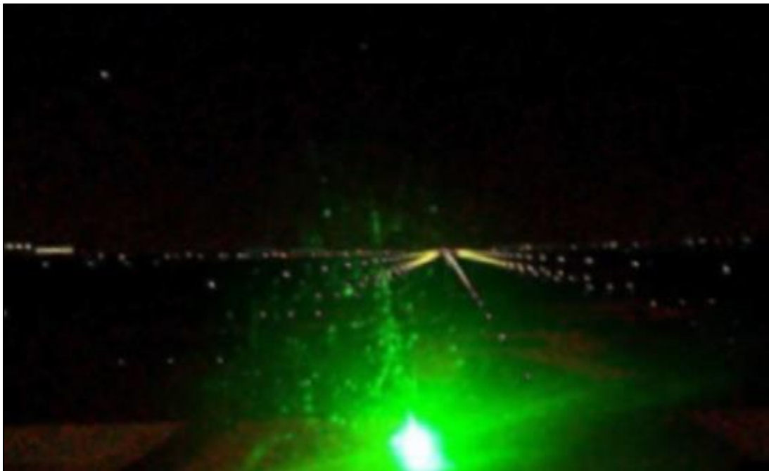
Figura 1. Lumina generată de laser nu obstrucționează luminile pistei, dar este suficient de puternică încât să distragă atenția pilotului. Irradiație: 0.5 \mu\text{W}/\text{cm}^2 ; indicator laser: 5 mW; altitudine: 3 700 ft (1 130 m).
